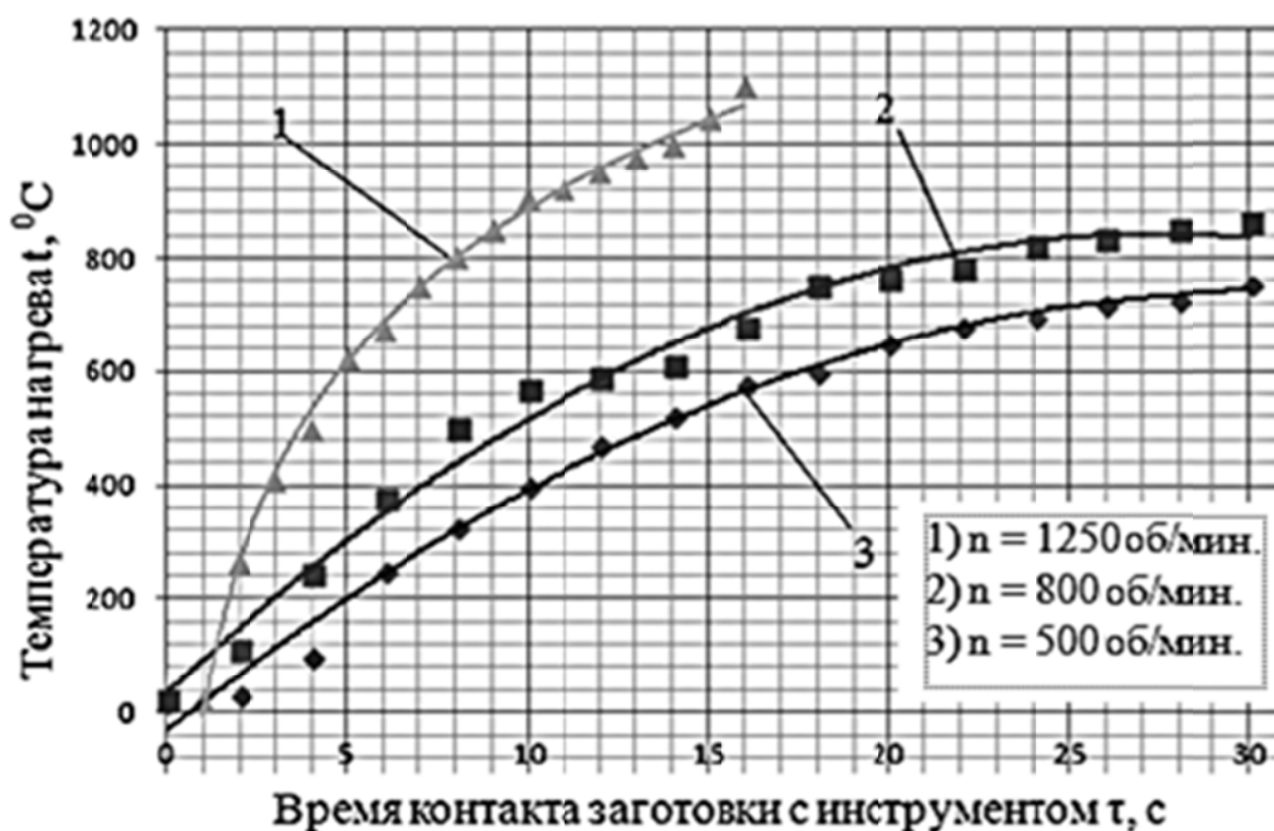
Рис. 2. Графики зависимости температуры нагрева от времени контакта заготовки с инструментом при различных скоростях вращения
